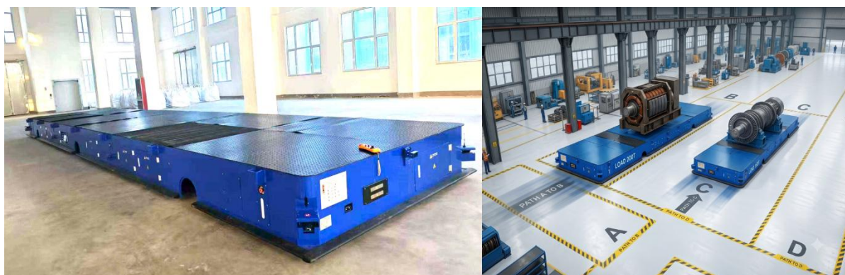
左:超重量物向け無人搬送車／右:大型製品・部品の自動搬送イメージ
