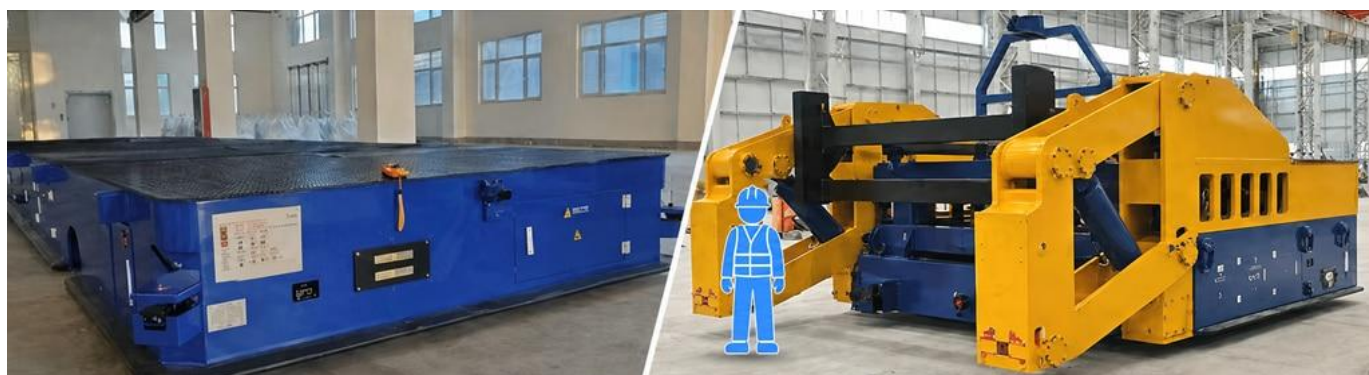
超重量物無人搬送車 RoboCar AGV の例
