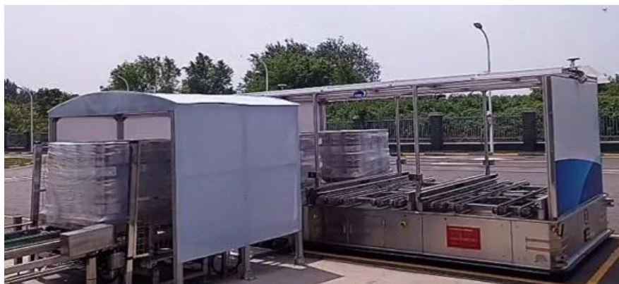
左：搬出・搬入用コンベア装置 右：コンベア内蔵 RoboCar AGV 10T - CV
