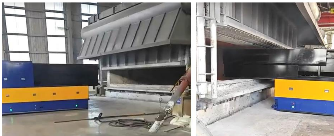
RoboCar AGV 50T - AI が溶解炉への自動給材を無人で行う様子
