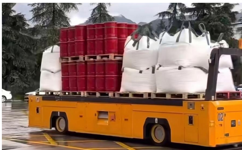
大型ドラム缶とフレコンバッグを積載した RoboCar AGV 10T
